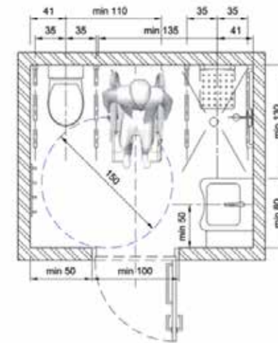
Figuur 3 - Douchekamer met wastafel en toilet
